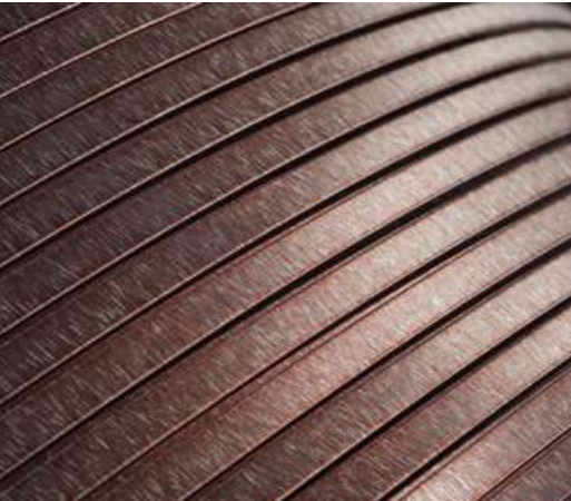
Емайлиран правоъгълен проводник, покрит с прежда смес стъкло/полиестер (Daglas®).
